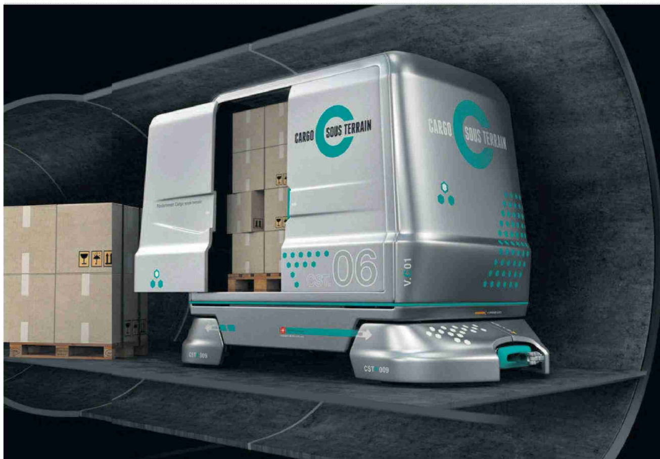
Containers Le système permet l'acheminement continu de palettes et de caisses. Résultat: un changement important des flux et une réduction des besoins en surface de stockage et en manutention. Les émissions de CO 2 par tonne de marchandise transportée seraient réduites de 80% et les nuisances sonores fortement diminuées.
